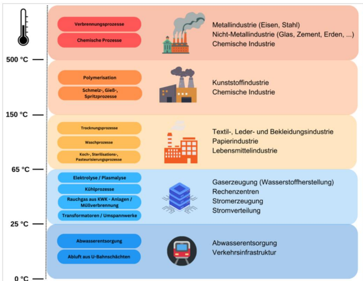
Abbildung 33: Temperaturniveau der Abwärme nach Industriezweigen Quelle: (Dunkelberg, 2023)
