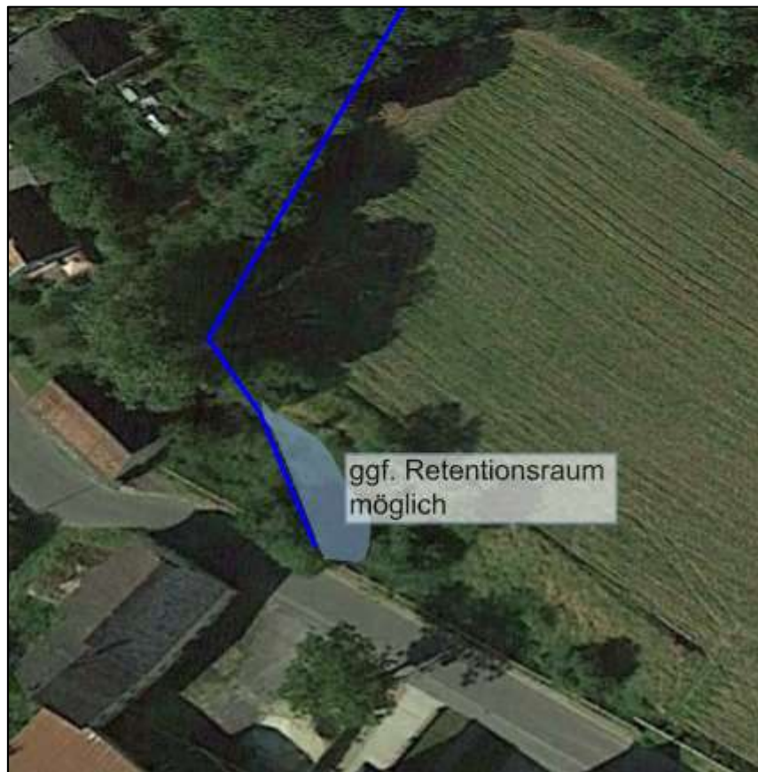
Abbildung 20: Möglicher Retentionsraum vor Durchlass an Dorfstraße
