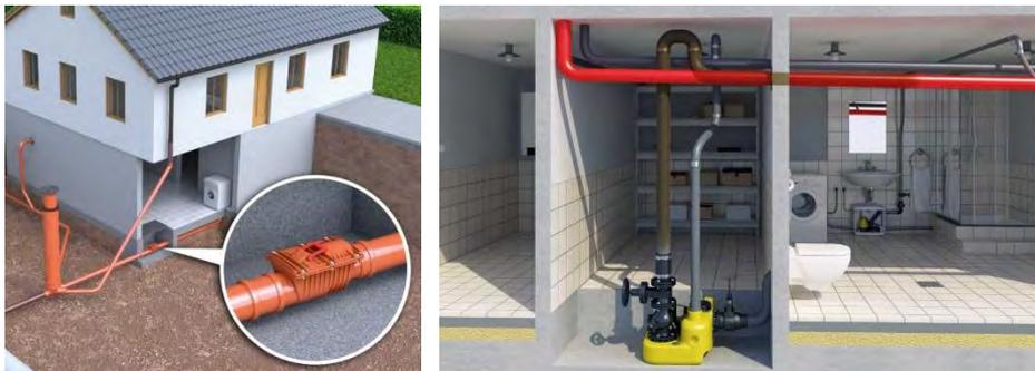
Abb. 13: Rückstauklappe und Abwasserhebeanlage (Funke Kunststoffe GmbH 2023; Das Haus Online 2023)
