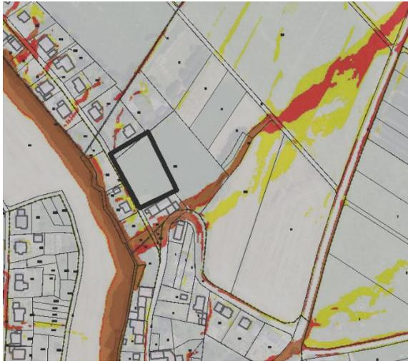
Das Gelände grenzt an den potentiellen Überflutungsbereich der Kailbachaue an. Die Analyse auf Basis des DGM 5 ergibt eine Konzentration von Niederschlagsabfluss im Nordwesten der Fläche, entsprechend ist die endende Konzentrationslinie bei einer potentiellen Planung zu berücksichtigen.
