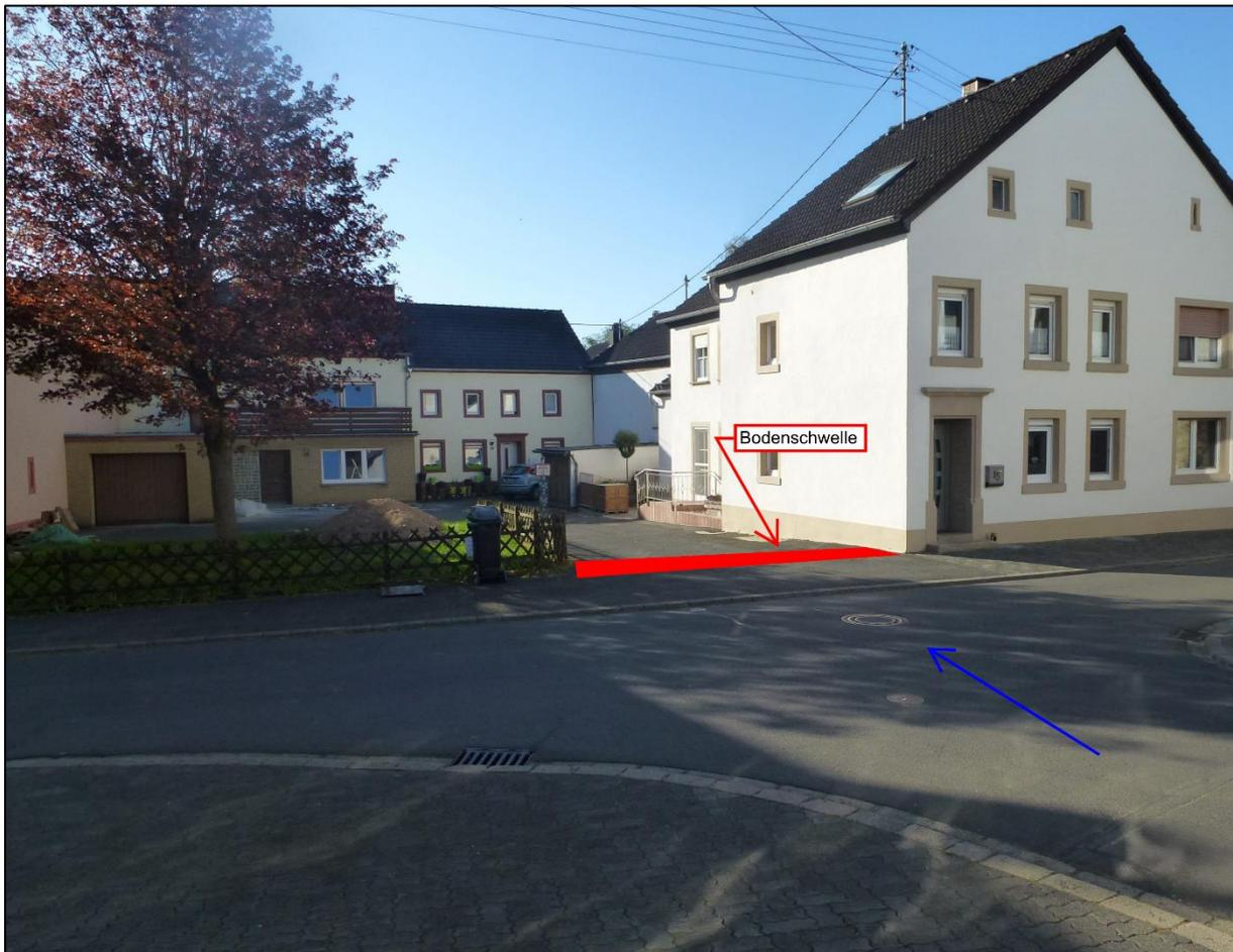
Abbildung 50: Kleine Bodenschwelle als Objektschutzmaßnahme
