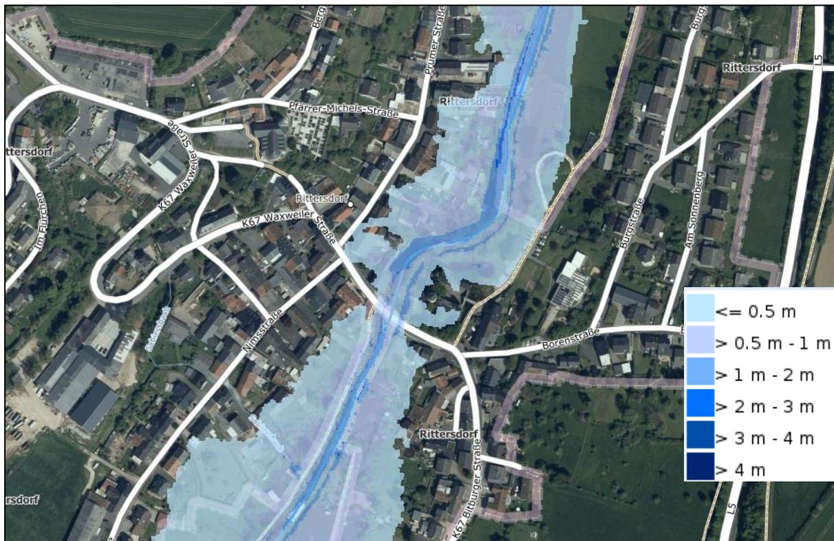
Abbildung 15: Wassertiefe an der Nims bei  $HQ_{\text{extrem}}$
