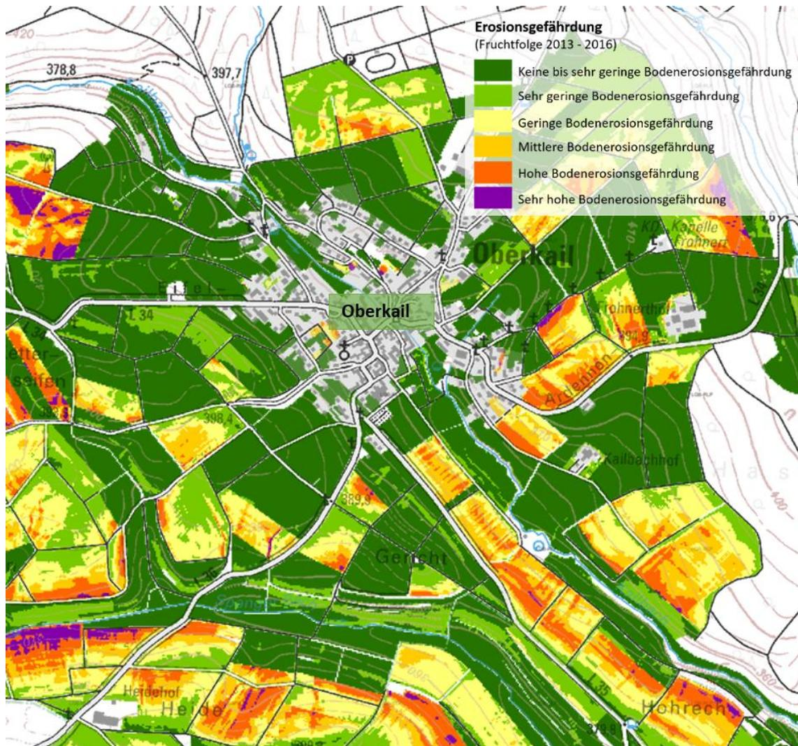
Abbildung 12: Erosionsgefährdung gemäß DIN 19708.
