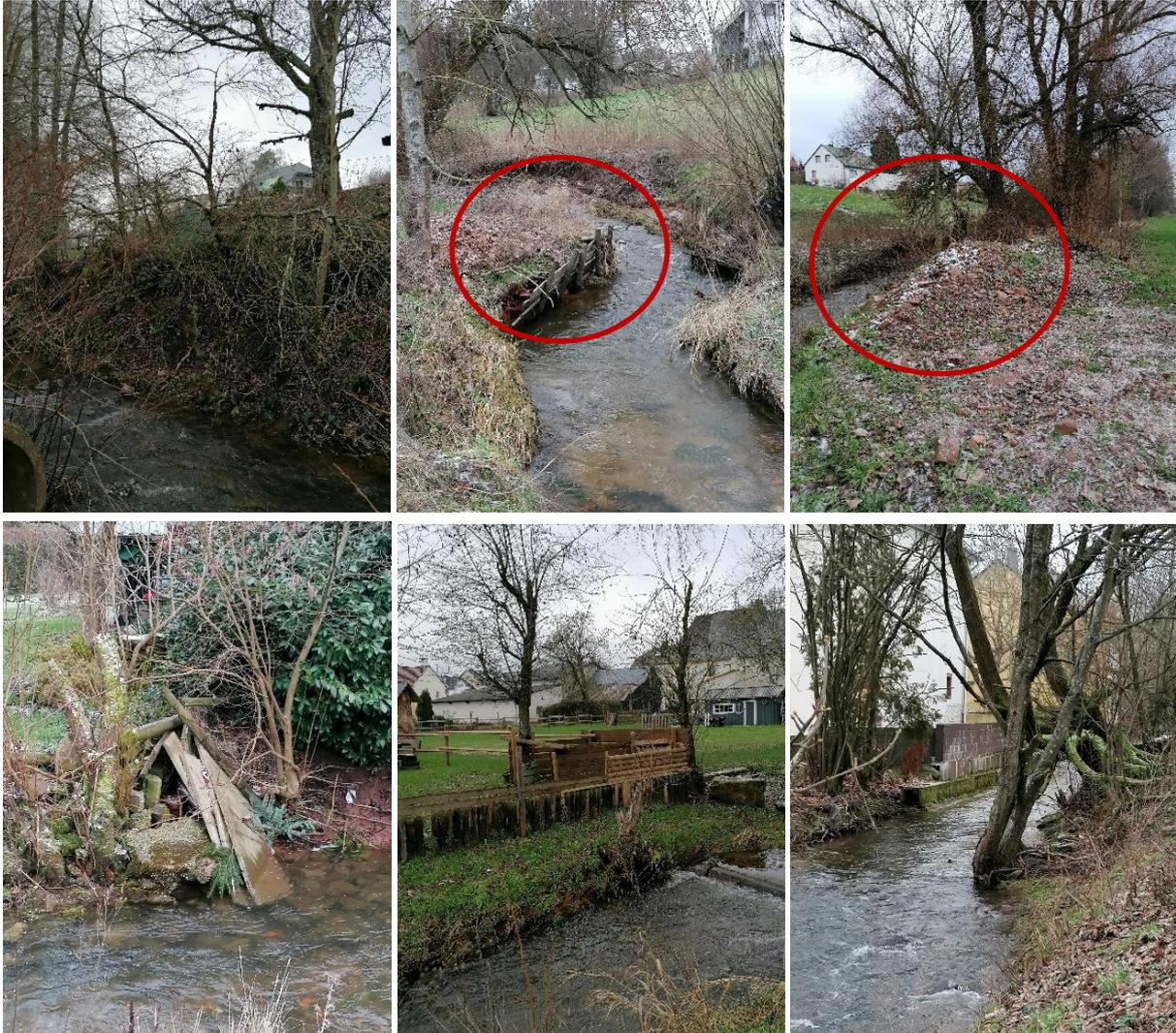
Abbildung 32: Lagerung von Materialien im Hochwasserabflussbereich sowie Einengung des Gewässerbettes durch Uferverbau (oben Mitte, unten rechts)
