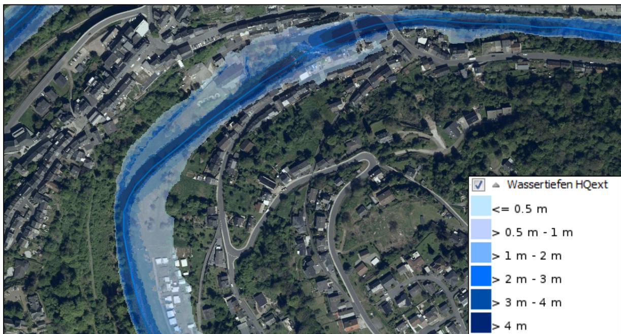
Abbildung 24: Wassertiefen im Überschwemmungsbereich bei  $HQ_{\text{extrem}}$
