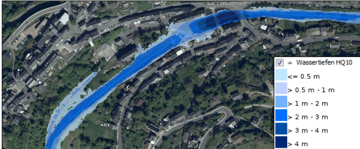
Abbildung 23: Wassertiefen im Überflutungsbereich bei  $HQ_{10}$
