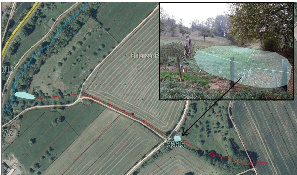
Abbildung 49: Fließrichtung und Puffermöglichkeiten Tiefenlinie "Steffelstein"
