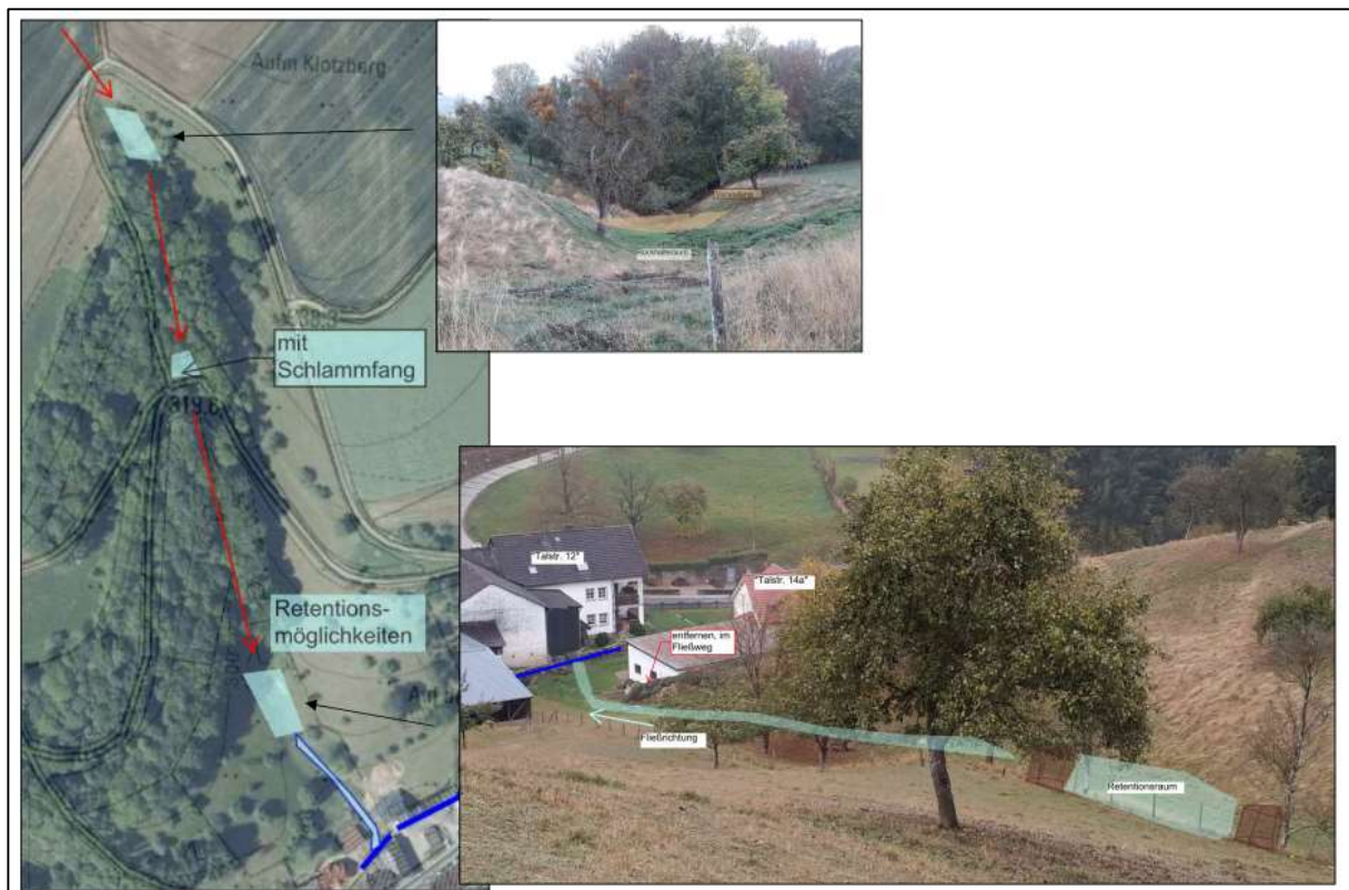
Abbildung 51: Übersicht Maßnahmenvorschläge Tiefenlinie hinter "Talstr. 12"
