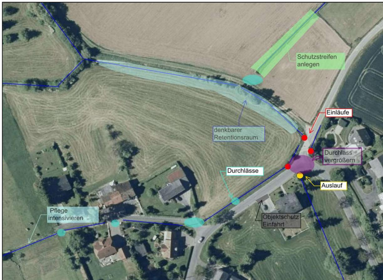
Abbildung 44: Visualisierung Verbesserungsmöglichkeiten Hoorbach
