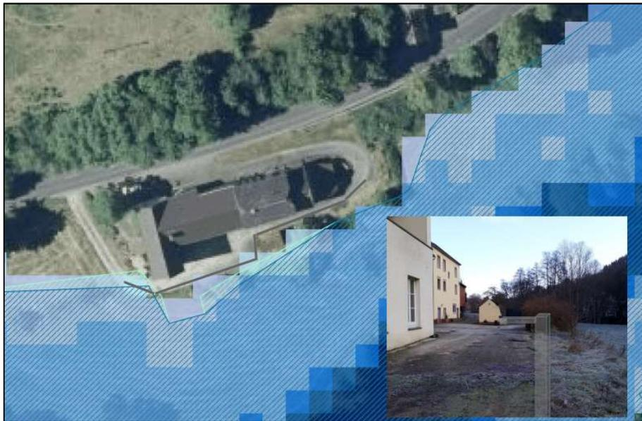
Abbildung 47: Bsp. Objektschutz Strategie Abschirmung mit kleiner Mauer „Prümtalstr. 11“
